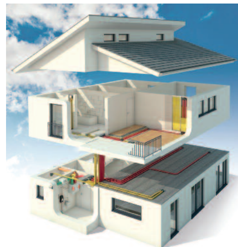
A gépi lakásszellőztetés axonometrikus vázlata
