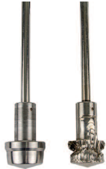
4. ábra – Szelepbetét (szeleptányér) a felületi erózió előtt és után
