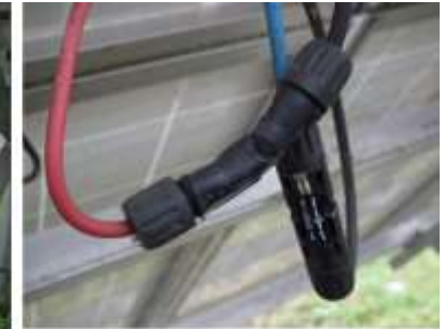
4. számú kép: hő hatására megrongálódott konnektor.
