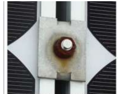
2. számú kép: szokványos anyagból készült anyacsavar.
