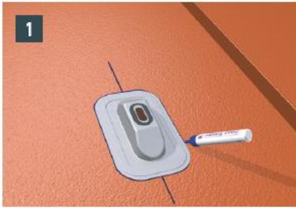
1 Körbejelölés, oválfurat bejelölése
